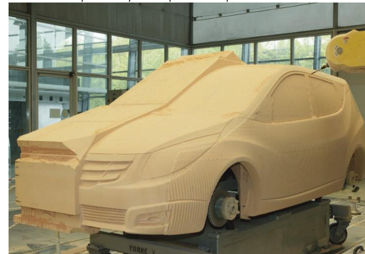
Полноразмерная модель из SikaBlock® M330, склеенная SikaBiresin® B260
