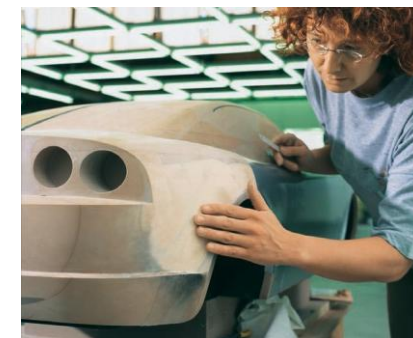
Модель из SikaBlock® PROLAB 65 N демонстрирует качество поверхности
